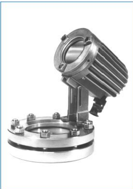
Kerek nézőüveg DIN 28120 szerint, DN 125, PN 10, termikusan előfeszített nátronüveggel DIN 8902 szerint (préselt kemény üveg), rászerezett CHEMLUX® L 20 deHSch típusú lámpával
