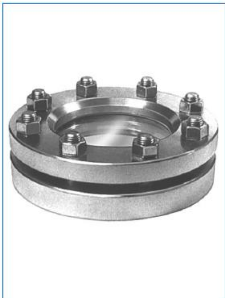
Nézőüveg, kerek, DIN 28120 szerint, DN 100, PN 10, termikusan előfeszített boroszlilikát üveggel DIN 7080 szerint
